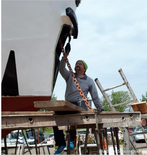
Hochdruckreinigers folgte die gründliche Reinigung des Schiffsrumpfes. Wir stellten fest, dass sich auf der Steuerbordseite im Bereich des Mittelkiels eine kleine Schadstelle befand, die schnell durch Schweißarbeiten beseitigt werden konnte. Der Kiel eines Schiffes ist das wichtigste Bauteil, an dem alle querstabilisierenden Spanten, wie
